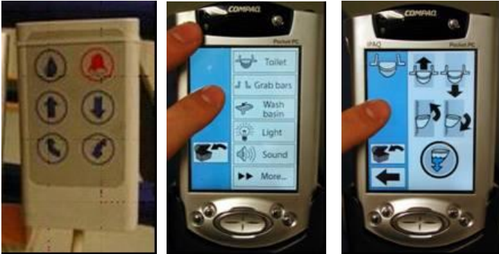
Konventionelle Handsteuerung (links), flexible Steuerung mittels PDA (Mitte und rechts).
